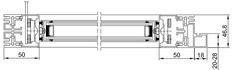
ARO 1 - Para alvenaria, madeira ou estruturas metálicas
